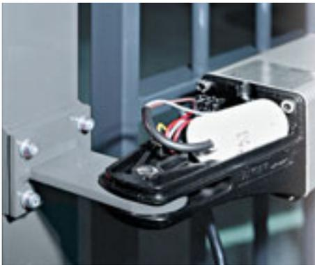
Détail du condensateur incorporé au moteur
