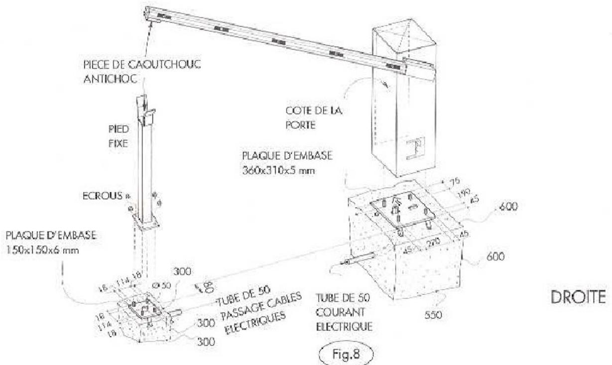
Après les opérations de fixation au sol, on procède à la pose et au raccordement des accessoires de sécurité comme la lampe de signalisation "LAPI 2", le contacteur à clé "SECH 15", la cellule photoélectrique "DIFO 33", l'interrupteur de coupure de l'alimentation et le ou les détecteurs magnétiques:
