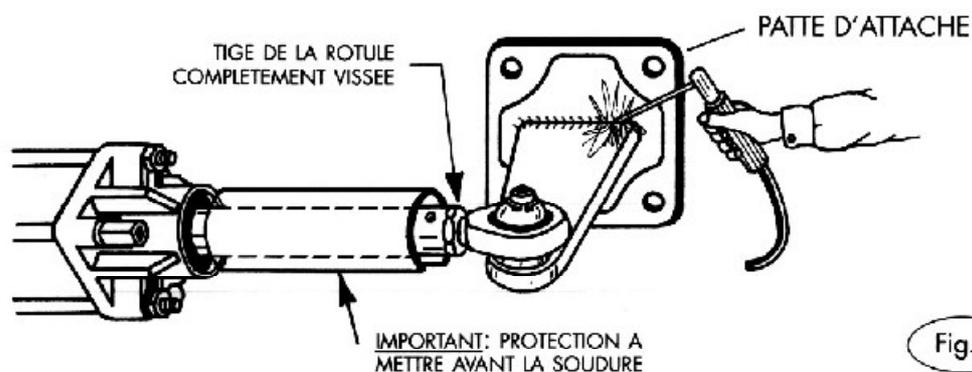
Après avoir fixé la patte d'attache sur le vantail, il faut dévisser la tige filetée de 5 ou 6 mm. et bloquer avec le contre-écrou pour obtenir une fin de course complète du vantail en fermeture ( dessin n°6).
