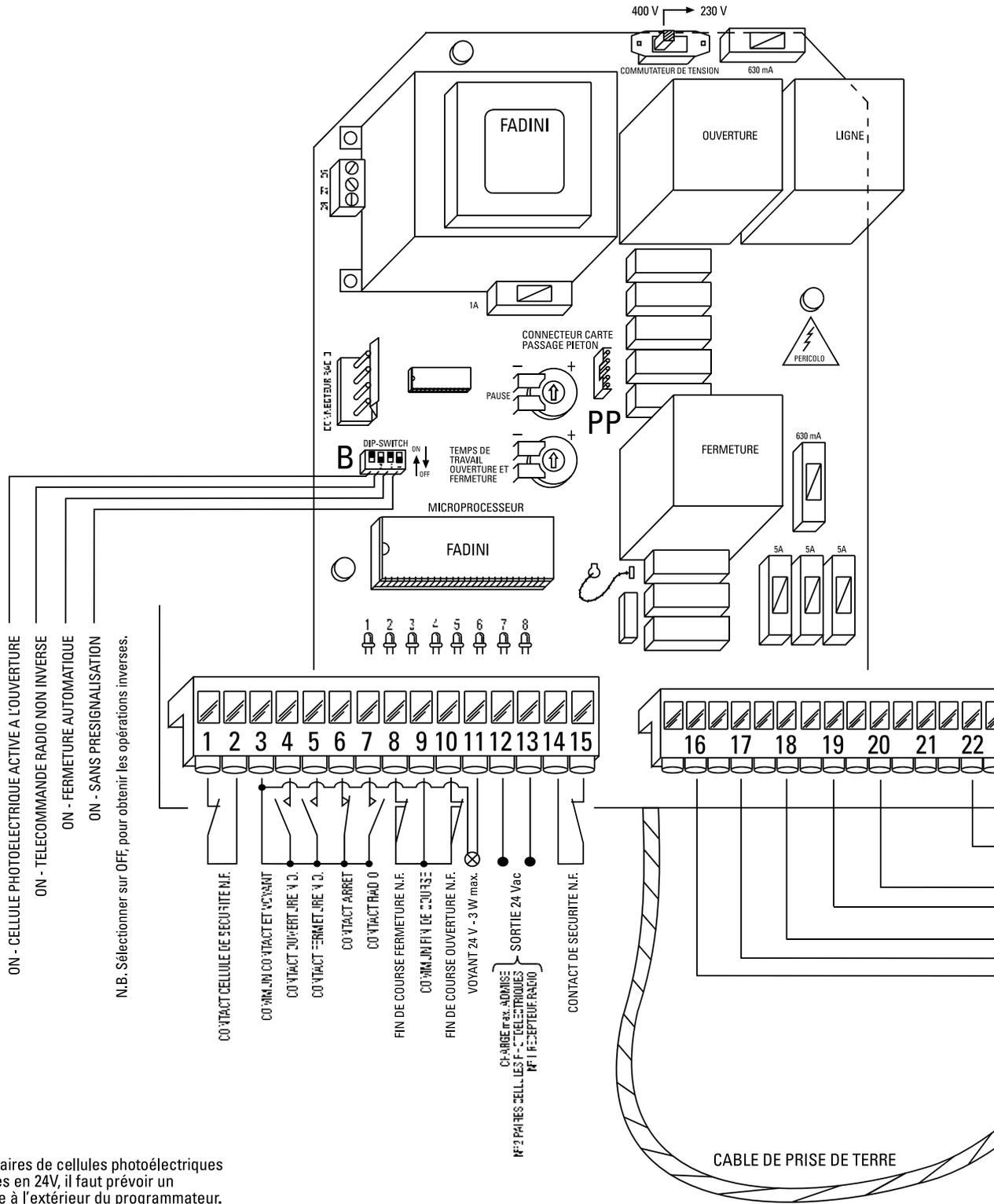
Si on utilise plusieurs paires de cellules photoélectriques ou d'autres accessoires en 24V, il faut prévoir un transformateur auxiliaire à l'extérieur du programmeur.
