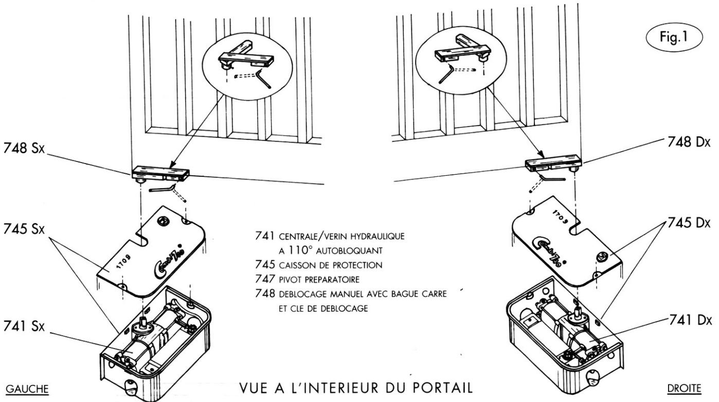
Si on veut automatiser le portail dans le futur, on peut préparer seulement le caisson en utilisant le pivot préparatoire et puis dans un second temps installer le vérin/pompe oléodynamique. (Fig. 2).
