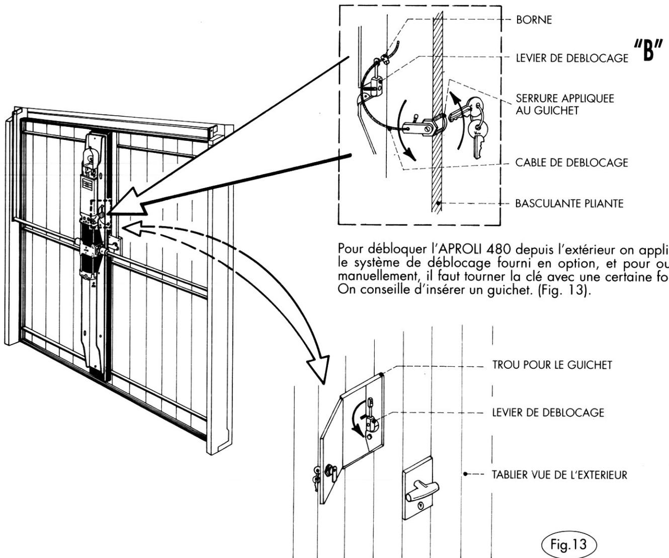
On fait l'installation d'un déblocage manuel extérieur par une serrure appliquée sur le tablier, à côté du levier de déblocage, au moyen d'un câble souple en acier, fixé au levier de la serrure. Il est préférable de réaliser un guichet de 12x12 cm au niveau du levier de déblocage pour y accéder directement.
