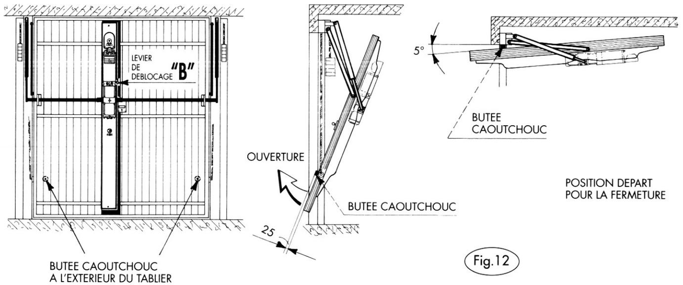
Il est nécessaire d'avoir plus de force de poussée surtout au départ en fermeture; par conséquent il faut appliquer des butées en caoutchouc pour faire l'épaisseur pour tenir la basculante inclinée de 5 degrés. (Fig. 12).
