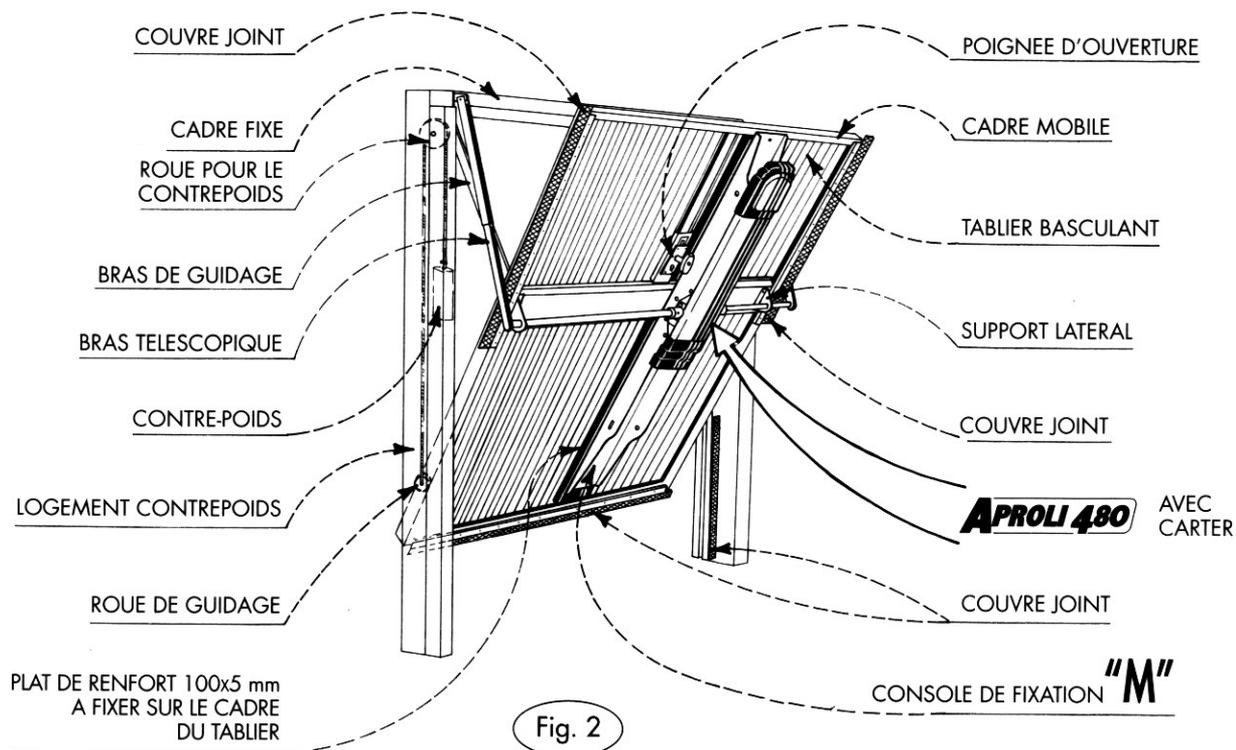
L'installation ne requiert aucune modification de la porte basculante. Il est possible d'obtenir le fonctionnement automatique ou manuel de l'extérieur ainsi que de l'intérieur, au moyen d'un levier "B" en débloquent le dispositif hydraulique. (Fig. 1).
