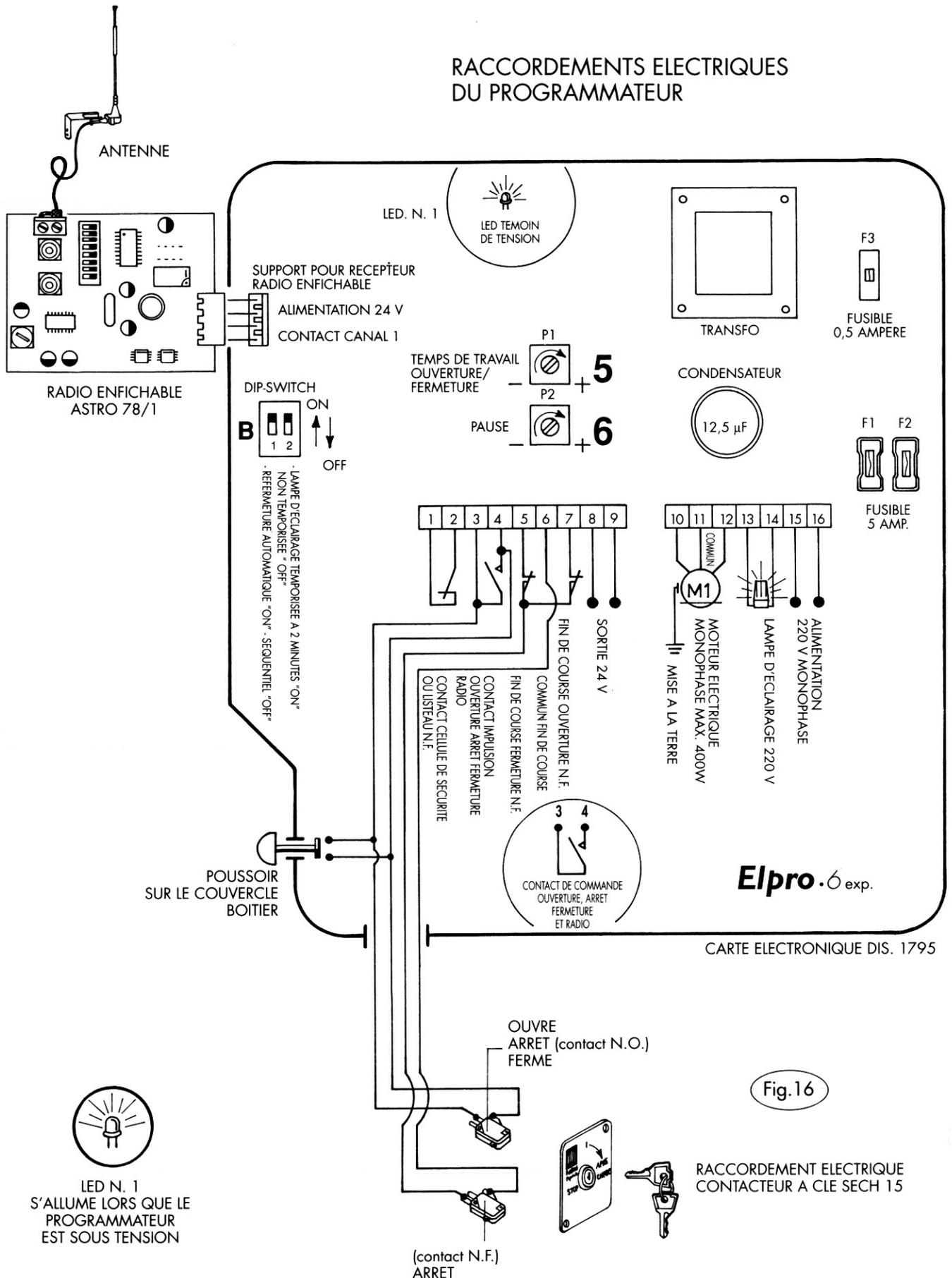
Faire les raccordements électriques du programmeur électrique en suivant le schéma. Dis. 1795 ELPRO 6 EXP: on peut utiliser tous les raccordements des bornes pour le poussoir d'ouverture-arrêt-fermeture, cellule photo-électrique, éclairage de service, radio commande avec seulement les contacts 3 et 4 (ouverture avec une impulsion, arrêt avec la seconde impulsion, réouverture avec la troisième impulsion - même cycle en fermeture).
