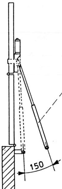
Avec le portail fermé le bras doit avoir un débattement de 150 mm en plus par rapport à l'attache au mur pour obtenir une poussée en fermeture parfaite (voir dessin).
