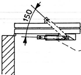
Important: le bras doit avoir un débattement de 150 mm en plus par rapport à l'attache sur le deuxième vantail, pour obtenir une bonne ouverture et un fonctionnement parfait (voir dessin).
