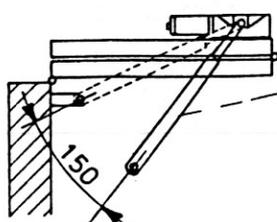
Important: le bras doit avoir un débattement de 150 mm en plus par rapport à l'attache du mur, pour obtenir une bonne ouverture et un fonctionnement parfait (voir dessin).
