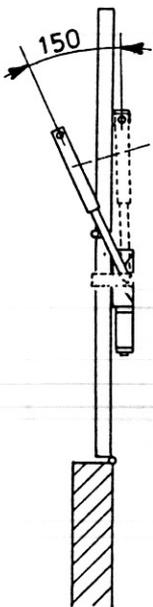
Avec le portail fermé le bras doit avoir un débattement de 150 mm en plus, pour obtenir une poussée parfaite en fermeture (voir dessin).
